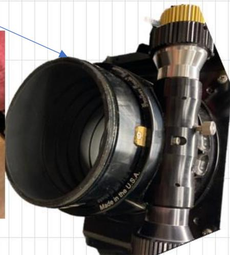
**Je dois remplacer la bague actuelle par une nouvelle bague qui accueillera le renvoi coudé 90 mm.** La bague se verra sur le porte oculaire Feathertouch FTF-3515 comme actuellement.
