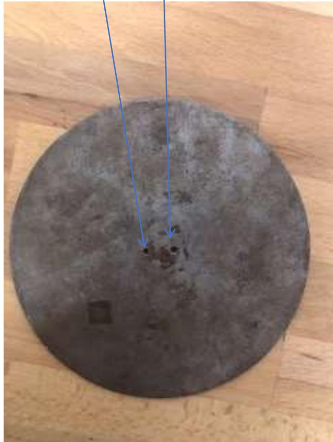
Sur la face du dessus, les trous ont un diamètre de 7mm
