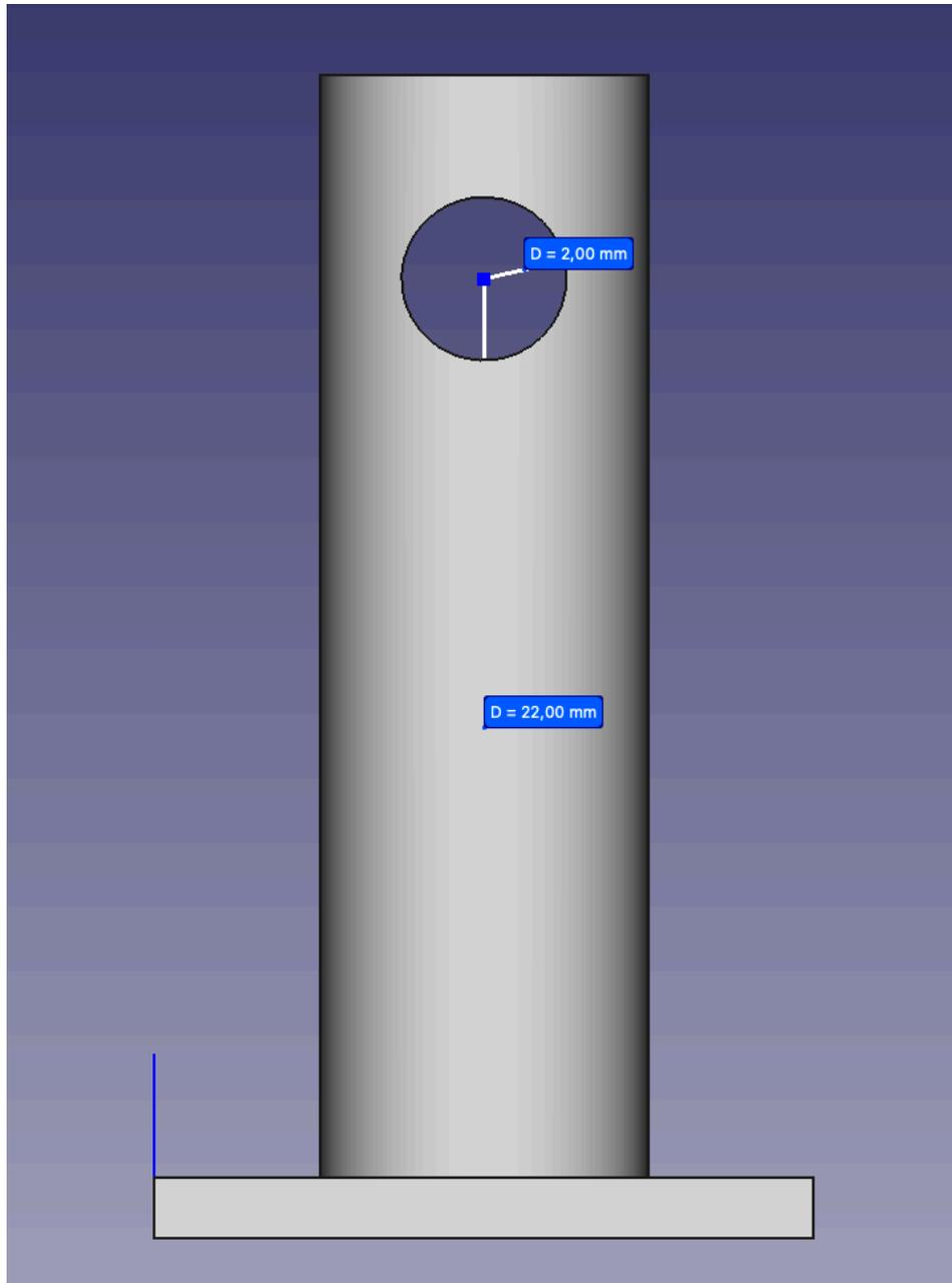
Le centre de l'alésage de diamètre 4mm est distant de **22mm** de la surface supérieure de la plaque carrée.
