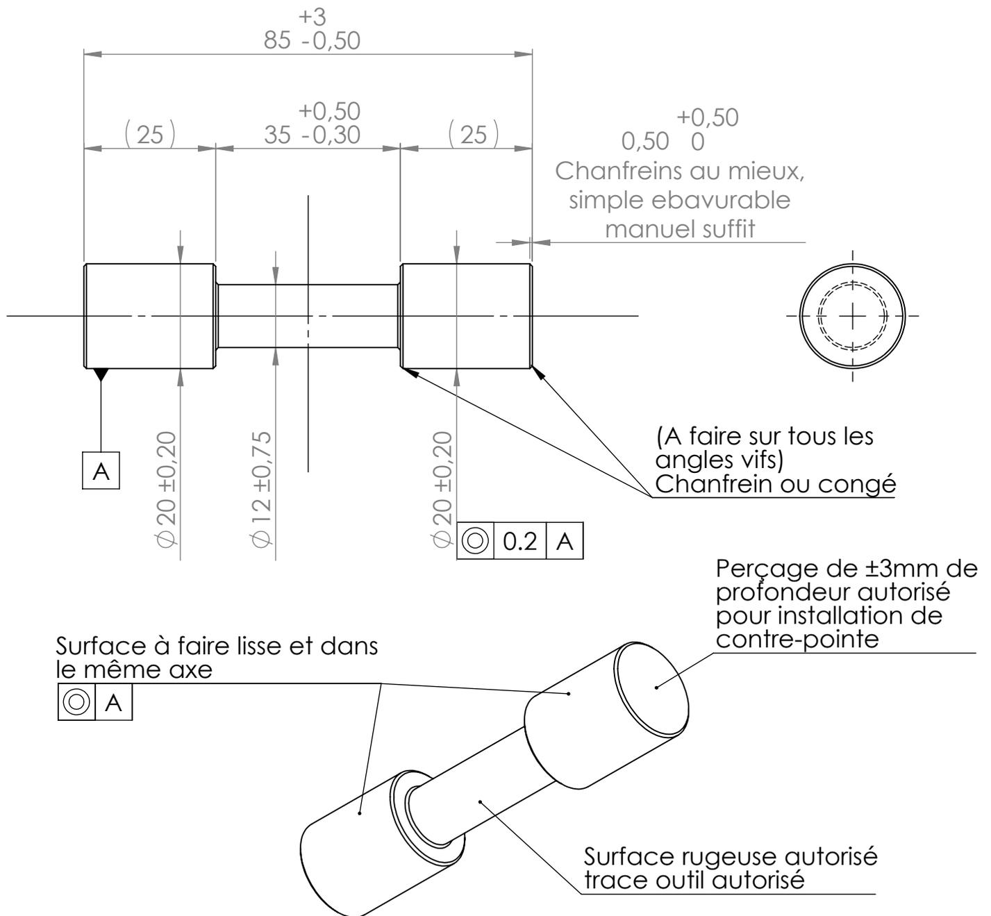
**-Matière en acier de résistance en cisaillement type S355 minimum selon stock et dispo, les maillons peuvent être de plusieurs alliages si cela permet de valoriser des chutes / rebus d'atelier (indiquer un code couleur ou marqueur si différent alliage acier)**
