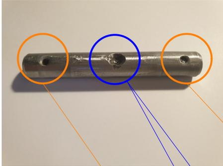
Orifices de graissage de l'axe
