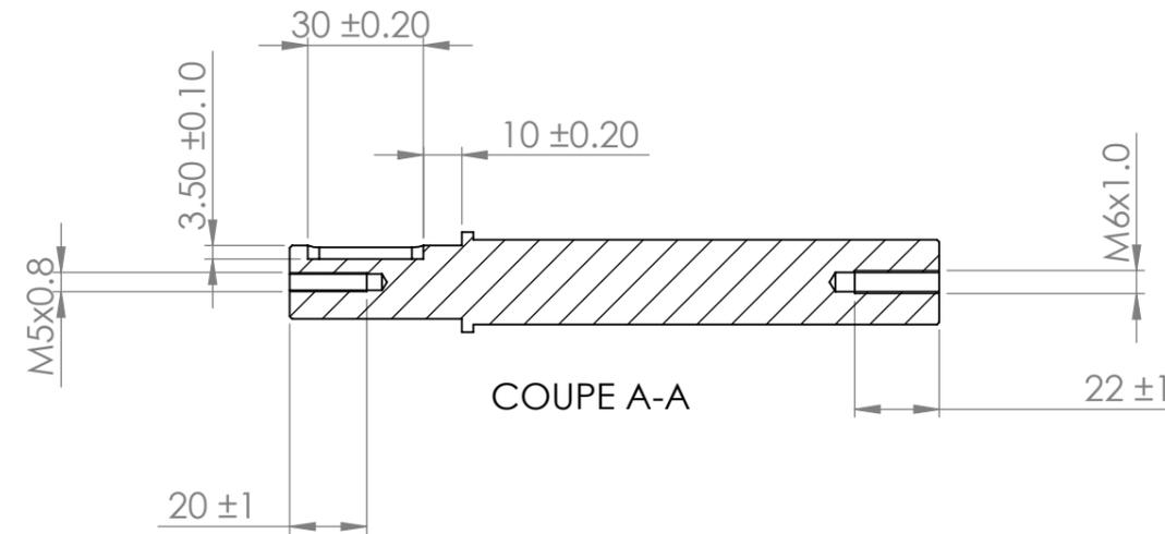
Rainure de clavette à ajuster avec la clavette
