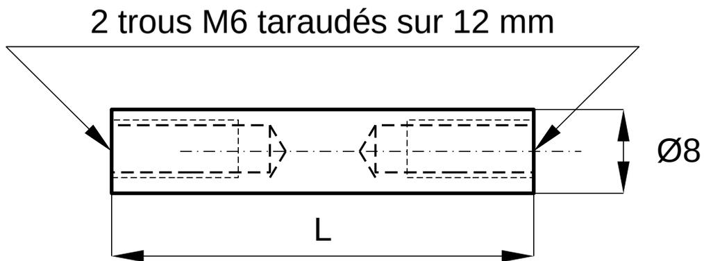
AXES ACIER CALBRÉ RECTIFIÉ GENRE « STUB »
