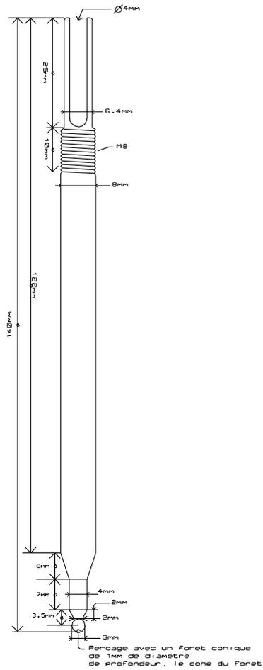
Usinage dans une barre cylindrique
