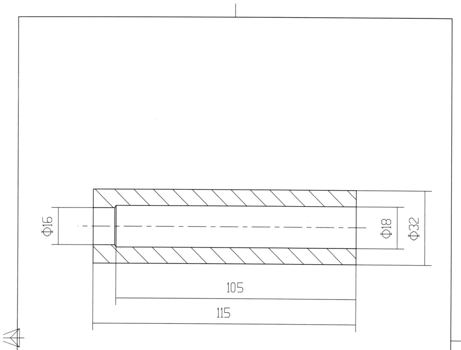
Les trous  $\Phi 18$  et  $\Phi 16$  restent bruts de perçage
