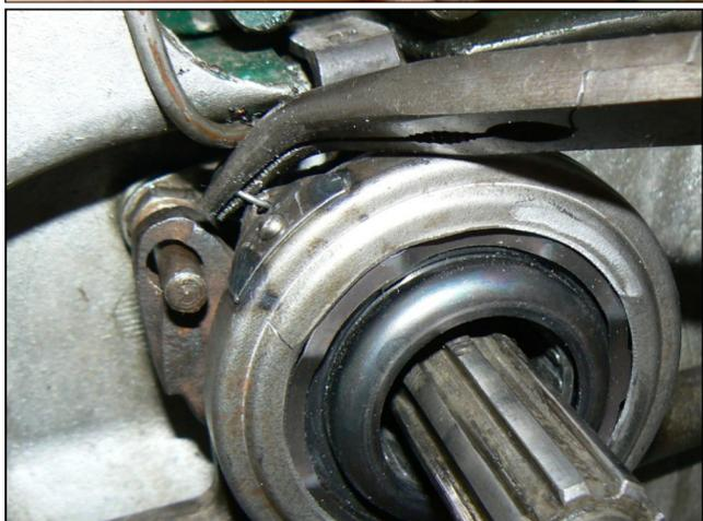
Remonter la butée, pour remonter le ressort j'ai trouvé plus simple de démonter le support et de remonter la patte et le ressort, dans le bon sens pour pouvoir l'encreur plus facilement sur la patte de la butée
