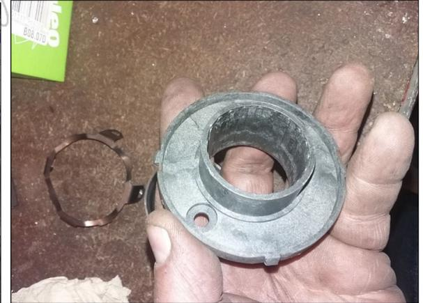
Il faut démonter la butée de 505. Déposer l'araignée a quatre pattes et retirer le roulement, percer les deux rivets de fixation et déposer le manchon de guidage. Sur la photo de droite le manchon tel qu'il sera fixer dans le corps de butée de traction.
