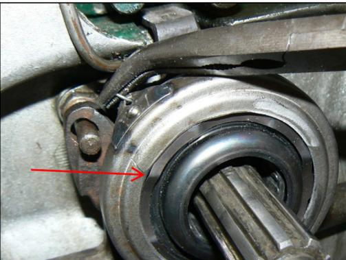
Remonter le roulement et le clipser sur le manchon à l'aide du ressort, ça passe juste juste pas facile de re-démonter. Ce ressort permet de maintenir le roulement sur le manchon tout en lui laissant une possibilité de glissement latéral qui assure l'auto centrage du roulement par rapport au cône du diaphragme du mécanisme. Cette fonction donne une sensation d'embrayage franche et toujours la même.
