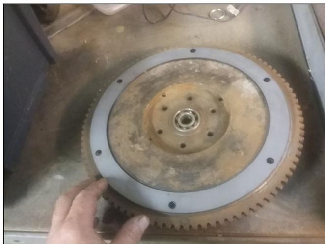
Il y a plusieurs type de volant moteur ici le même que ma traction à moteur perfo, mais le montage est identique sur les autres volant moteur.
