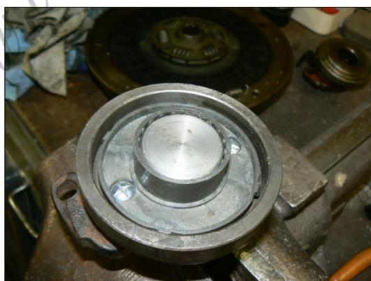
Le manchon étant parfaitement centré marqué le corps en fonte à l'aide d'un foret de 5mm dans la partie où il y a plus de matière puis percer à 3mm puis tarauder à M4 pas de 0,7. Fixer le manchon avec deux vis type poëlier M4 à diamètre de tête de 9,5mm standard.
