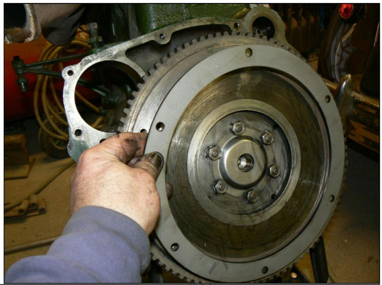
Positionner l'entretoise sur le mécanisme avec 3 goupilles de 6mm de façon que les trous de 8,5 tombent bien sur celui-ci .Maintenir l'ensemble avec des pinces étai. Sur la photo c'est mon gabarit de perçage car l'usineur avait oublié les trous de 6mm sur l'entretoise et ma refait une entretoise beaucoup plus épaisse avec tout les trous. Percer le mécanisme a 8,5. Positionner l'entretoise sur le volant moteur.
