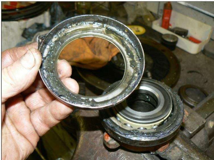
Pour déposer le roulement de butée, déposer le cache tôle. Il est maintenu par trois vis rapide, ont trouve ces vis en neuf chez FRANSSEN ou autre pour 0.33€ pièce.
