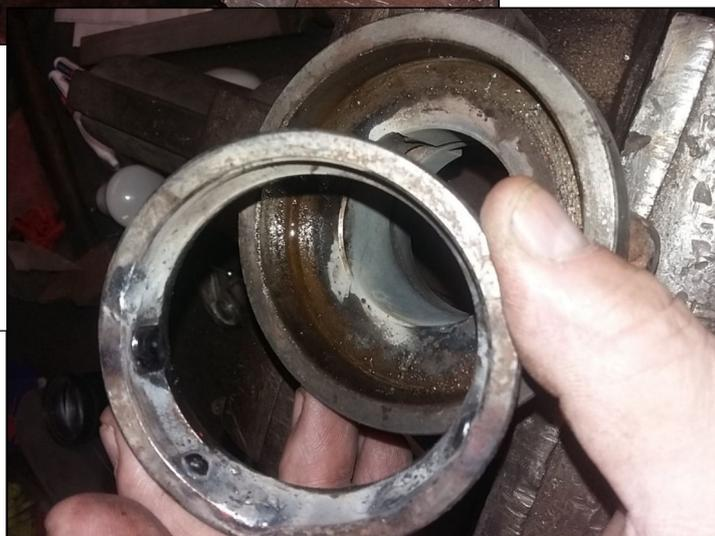
Déposer le roulement a la presse. Pour déposer la cage qui reste dans le corps, il suffi de faire 3 points de soudure a l'arc dans la cuvette et ensuite il vient toute seul.
