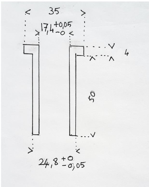
Cette bague sert de palier pour un pivot en alliage d'aluminium anodisé de 17,35 mm de diamètre.
