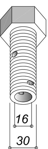
2 percages  $\text{\O} 6$  (2 boulons  $\text{\O} 6 \times 40$  pour fixer sur le rouleau supérieur)
