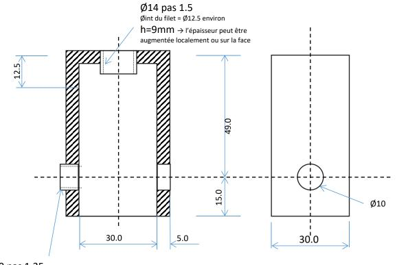
$\emptyset$ 10 pas 1.25 (Øint du filet = Ø8.7 environ) h=7mm  $\rightarrow$  l'épaisseur peut être augmentée localement ou sur la face
