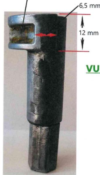
Pas de vis inversé pour vis de diamètre 4mm et longueur 14 mm
