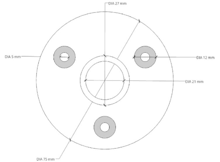
**Vue de face - Diamètre de perçage**
