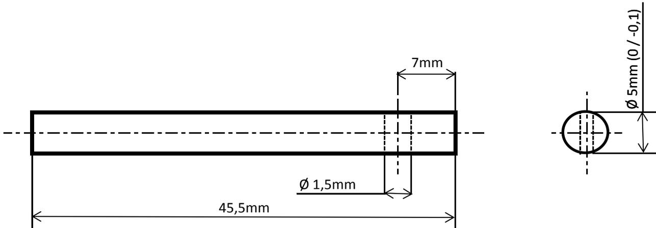
Nota: Les cotes de 7mm et 45,5mm sont de "bord à bord".
