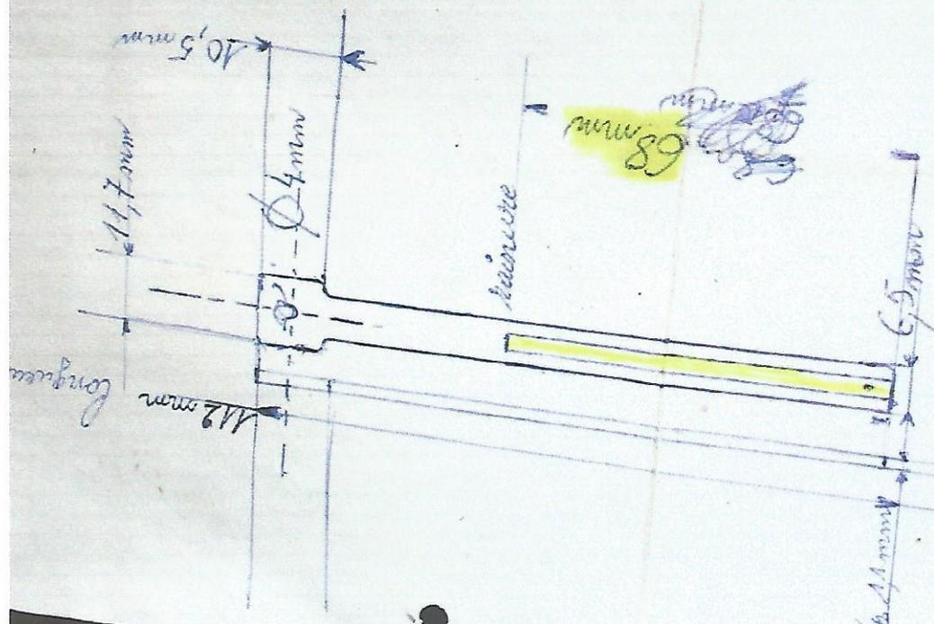
rainure centrale de 4 mm de profondeur } sur 1 face
