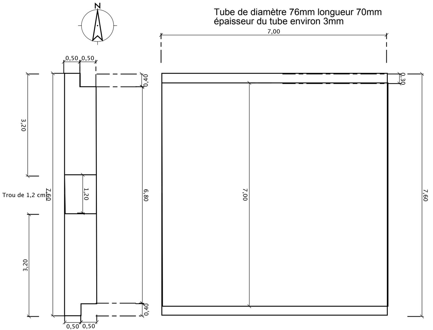
Tube de diamètre 76mm longueur 70mm
