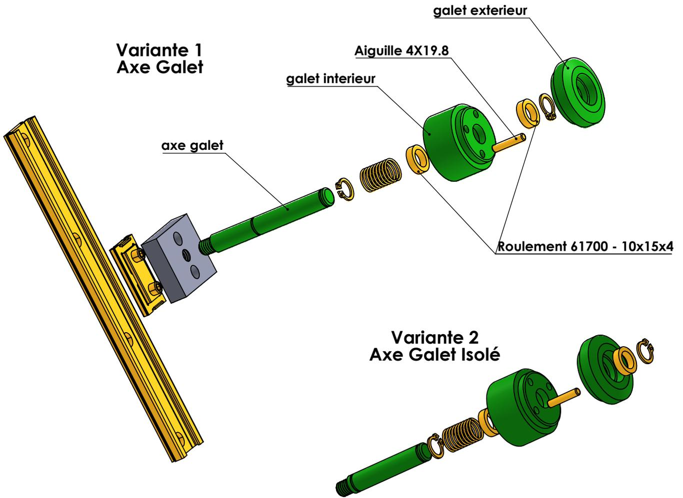
Les deux pièces "galet" sont montées sur roulement et tournent autour de l'axe.
