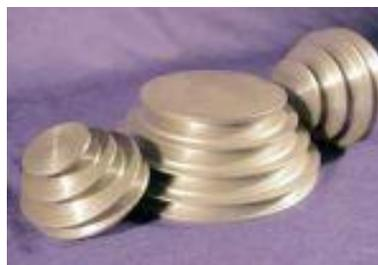
Les poulies étagées sont utilisées lorsqu'un système basique de variation de vitesse est nécessaire.
