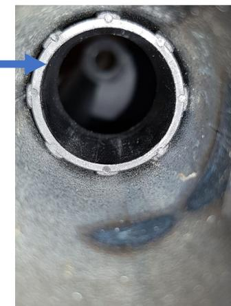
Insert en résine lisse qui guide le tube acier poli. Insert monté à force et positionné dans tube support par un épaulement
