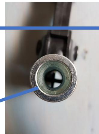
Empreinte conique en extrémité de tube, logement de l'écrou conique de l'axe de roue
