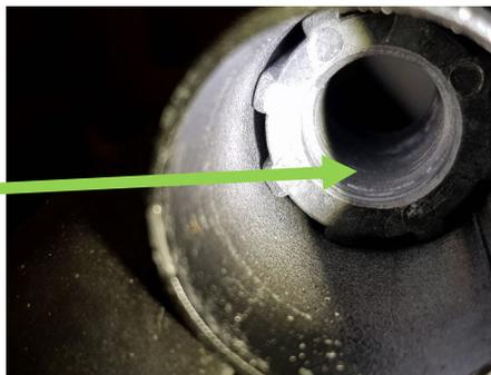
Insert en résine taraudé M18 dans tube roulé soudé. Monté à force et positionné dans tube support par un épaulement
