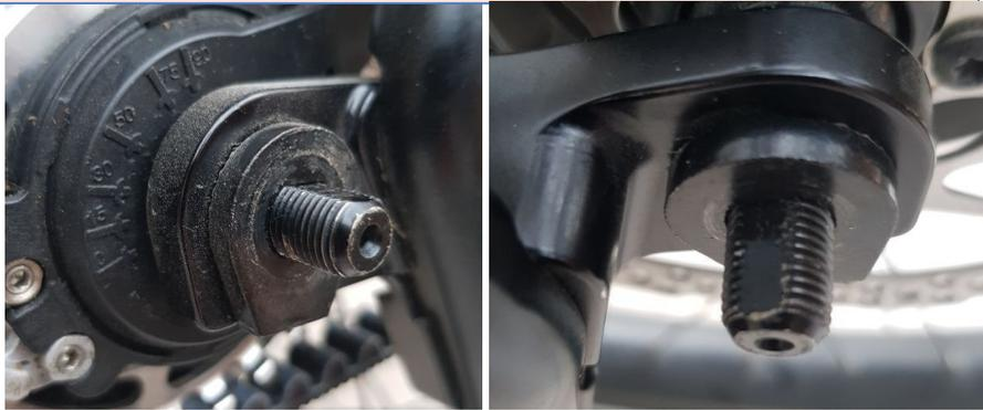
Écrou d'axe de roue arrière en inox
