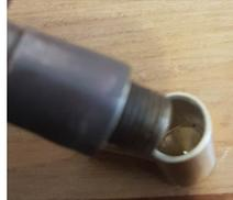
Pour la partie femelle du coude laiton elle est trop grande ce qui fait qu'il est impossible de visser le tube laiton sur cette partie. Je voulais un raccord femelle pas de vis 10x1.
