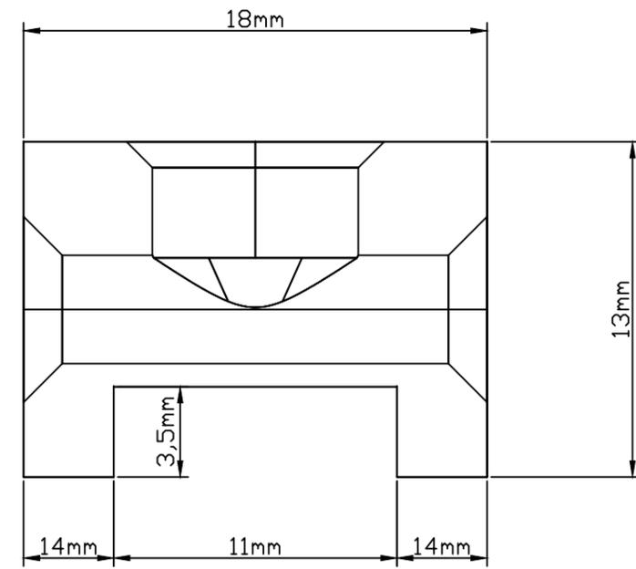
**Block d'entraînement de l'arbre de la grignoteuse double tête Tempsa - en acier trempé**
