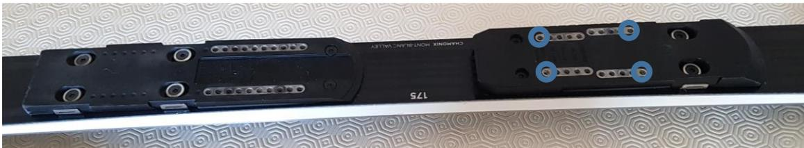
Photo 3 : Ski Dynastar avec sa plaque R22, qui doit recevoir l'interface (qui sera vissée dans les trous bleus)
