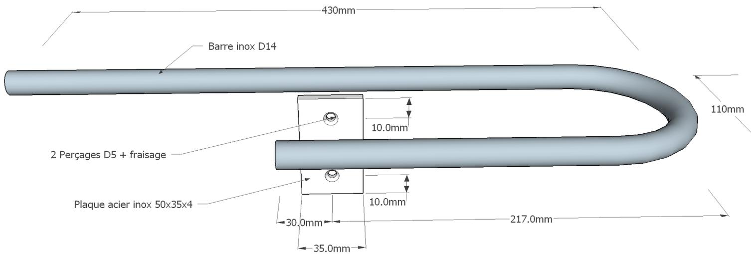
La plaque inox doit être soudée perpendiculairement au plan de la barre
