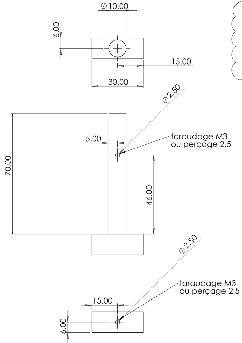
Matière Aluminium un peu dur. Les taroudages sont à réaliser si possible, sinon trou 2,5 mm. Pièces a réaliser en 4 exemplaires. Côtés en mm
