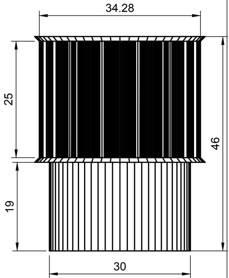
Poulie 14 dents pour courroie type HTD8 de 25mm de diamètre.
