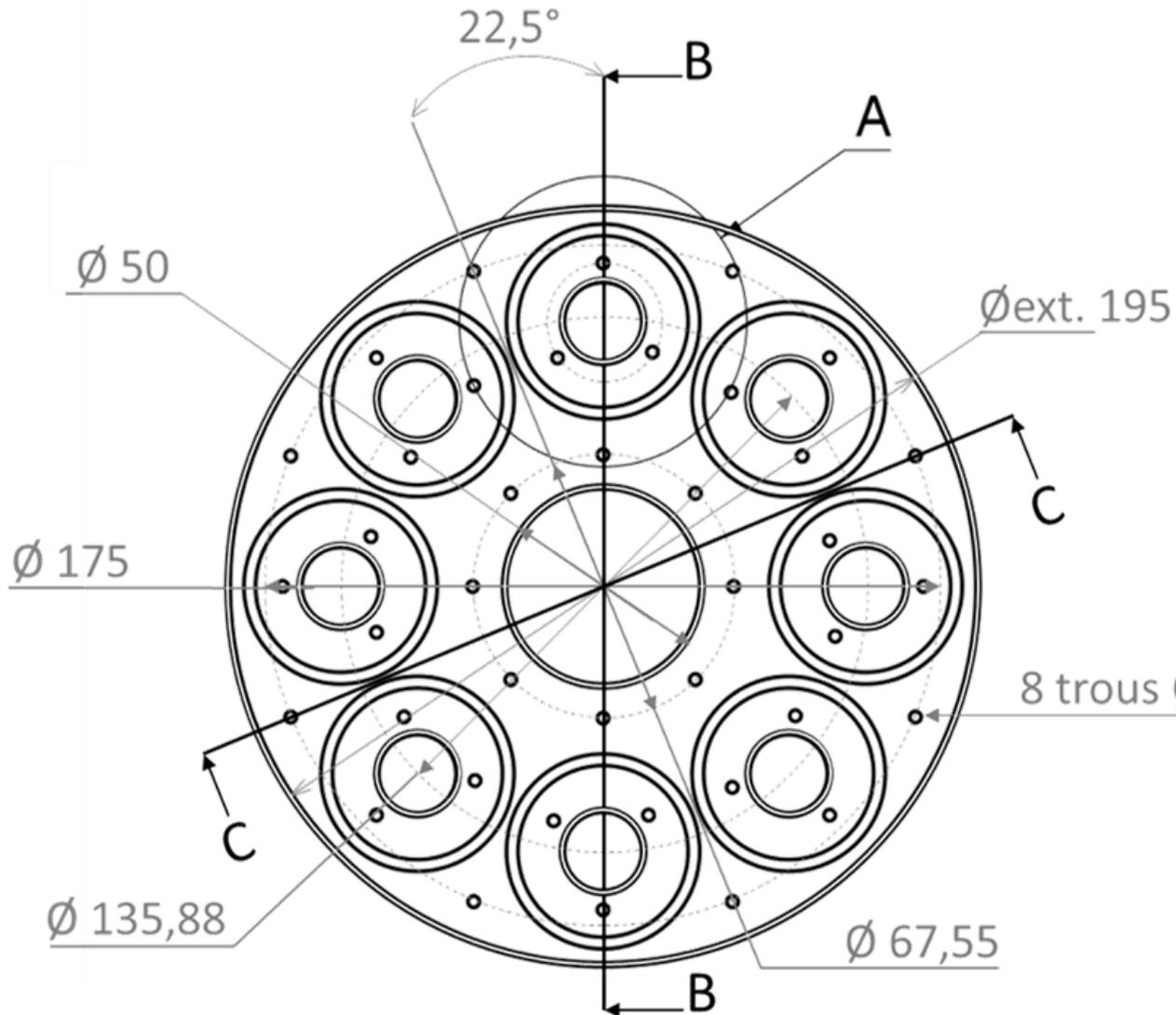
3 trous  $\varnothing 3$  espacés de  $120^\circ$  sur  $\varnothing 30$
