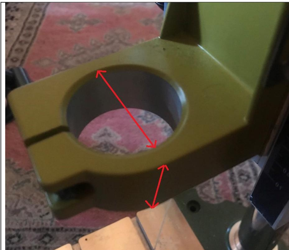
Hauteur de la bague de serrage : 25.04 mm
