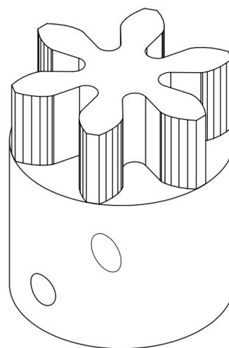
profil suivant CAO (denture droite module 4 6 dent)
