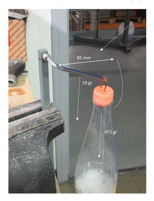
Le taraudage de la pièce plastique n'a pas été réalisé complètement pour laisser une force résiduelle dans l'action de visser; ceci pour conférer à la vis de réglage une propriété d' »indesserrabilité« . On veut caractériser cette propriété par un couple, mais la clé dynamométrique disponible ne permet pas de mesurer ce couple.
