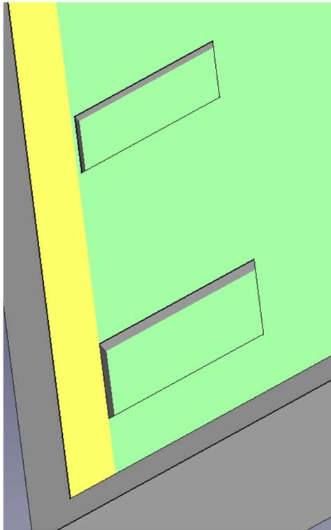
Leamage de gauche fait 1 mm de profondeur (rectangle 21 x 10 mm, cotes à 1 mm de profondeur).
