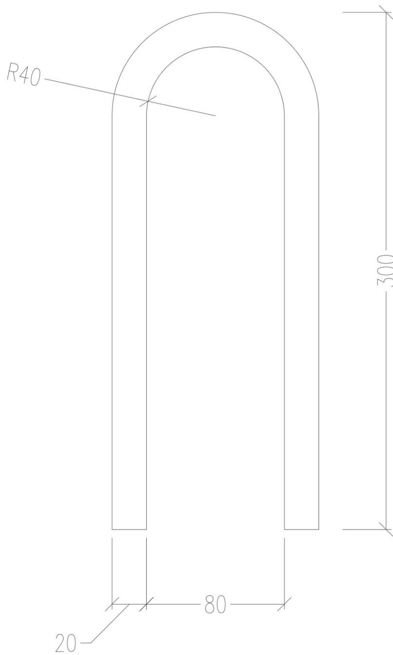
Cintrage de 2 pièces tube rond acier diamètre 20mm
