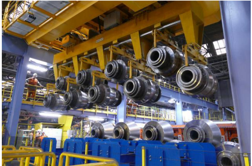
Figure 13 Nouvelle redresseuse à galet - Train n°2
