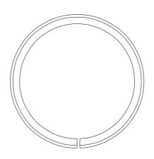
Matière : AU4G ou équivalent Diamètre extérieur : 50-0,1 Diamètre intérieur : 43+0,1
