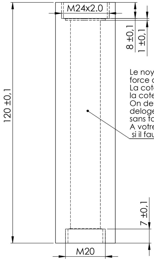
Le noyau capteur devra s'insérer en légère force dans son alésage d15mm.
